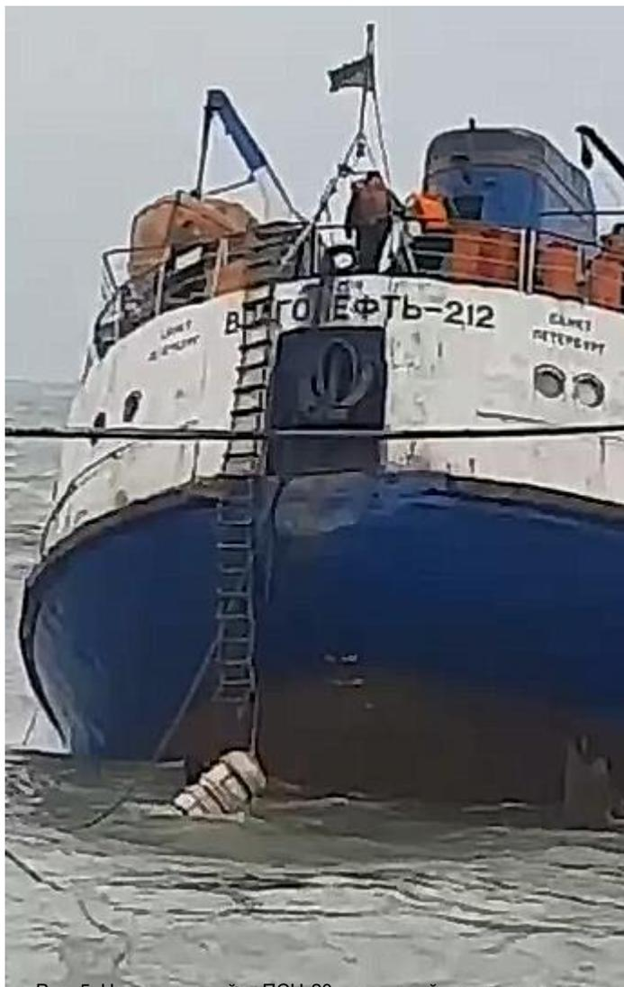
Рис. 5. Нераскрывшийся ПСН-20 у кормовой части танкера
