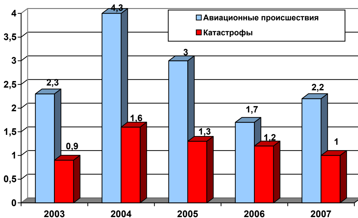
Рис. 6. Количество авиационных происшествий и катастроф на 100 тыс. часов налета на вертолетах в гражданской авиации государств-участников Соглашения (без АОН)
