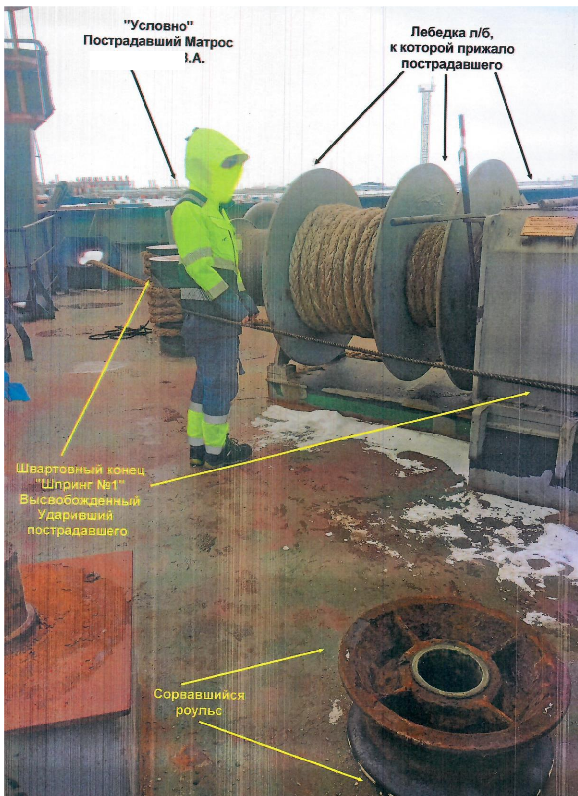
Рис. 5. Фотосхема места несчастного случая, произошедшего с матросом (после срыва роульса)
