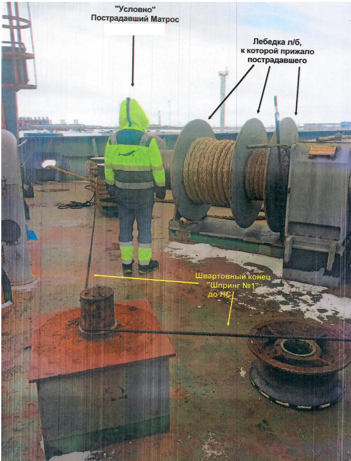
Рис. 4. Фотосхема места несчастного случая, произошедшего с матросом (до срыва роульса)
